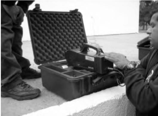
**Funcionamiento y manejo del detector de explosivos SABRE 4000.**
