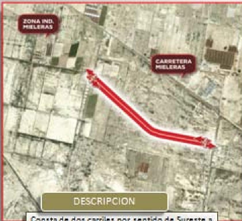
Consta de dos carriles por sentido de Sureste a Noroeste y viceversa, de 3.50 m de ancho por carril con un acotamiento lateral de 2.50m y camellón central de 4.00 m. De ancho.
